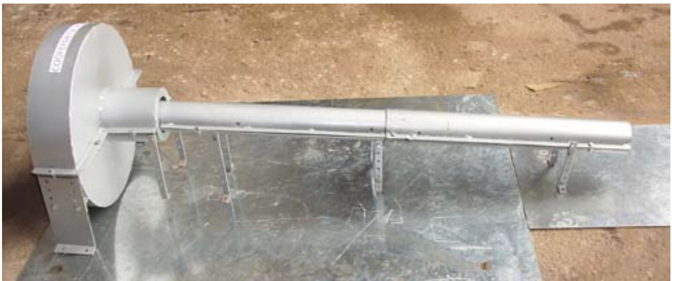
Este é o modelo desenvolvido para proteger o eixo descoberto de embarcações e, desta forma, evitar casos de escarpelamento
